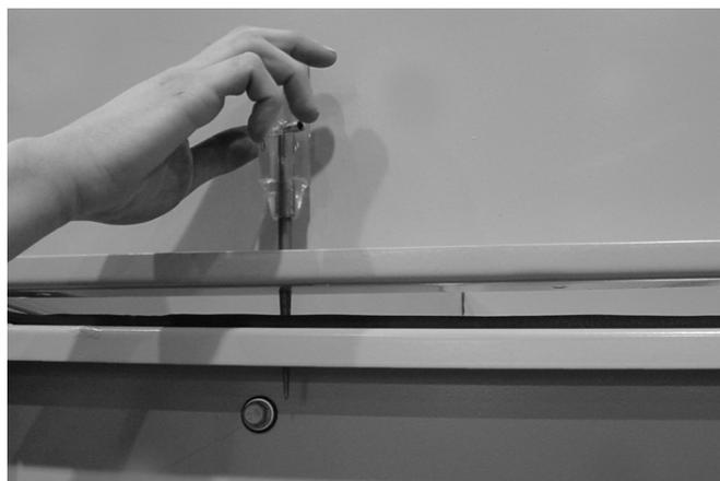
Figure 4: Utilisation des broches d'assemblage pour aligner les trous de vissage
