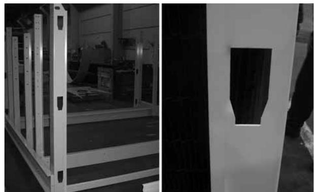
Figure 13: Guides de manutention femelles de la section plenum
