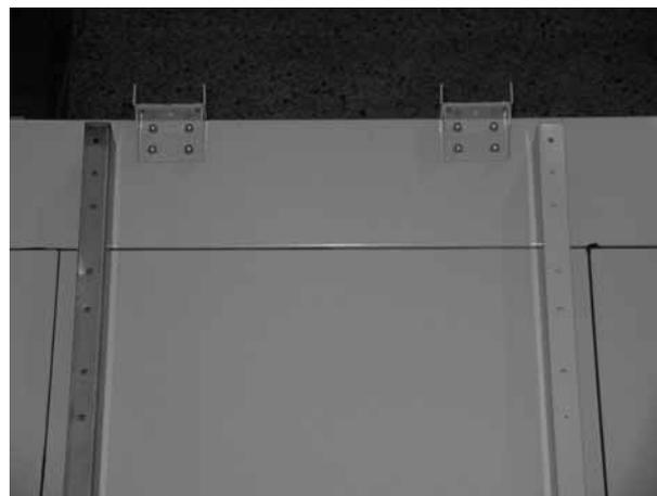
Figure 8: Vue détaillée des guides de manutention
