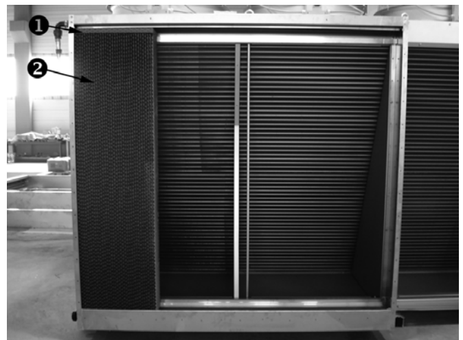
Figure 26: Installation du média du pré-refroidisseur
