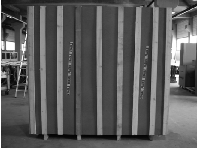
Figure 9: Caisse des sections de pré-refroidissement adiabatique
