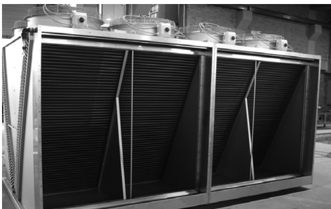
Figure 24: Cadre vide du pré-refroidisseur monté
